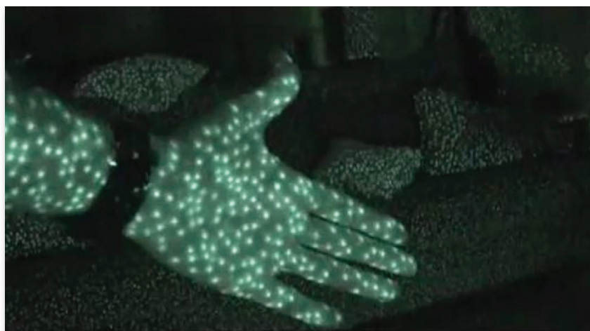
Abbildung 19 - Kinect Infrarotmatrix durch ein Nachtsichtgerät
