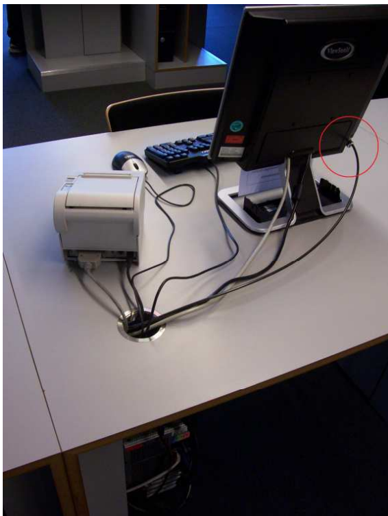
Abbildung 7: Gerätesicherung an einem Rechnerarbeitsplatz in der WLB Stuttgart
