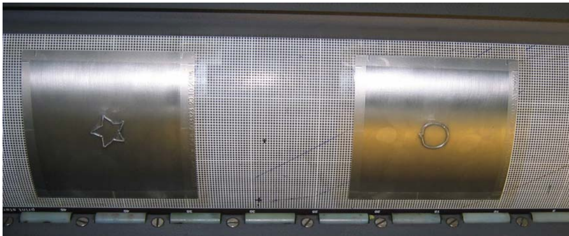
Abbildung 6.7 Stanzwerkzeuge für den Technic- und Design-Guide auf dem Magnettuch im Lackwerk
