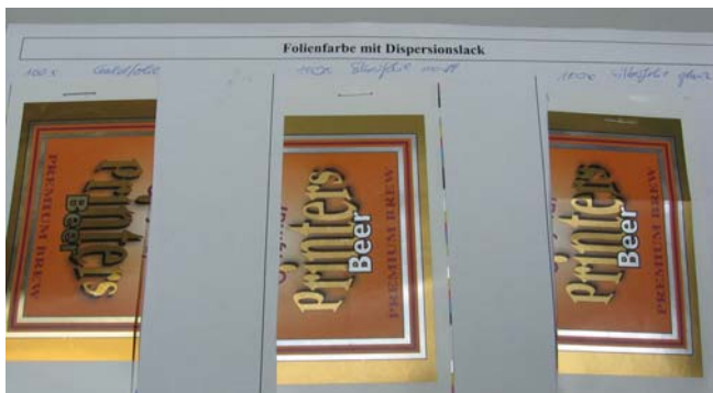
Abbildung 5.41 Scheuerfestigkeit der Huber Folienfarbe auf verschiedenen Metallfolien mit Dispersionslack, Belastung 100 Hübe (von links: Goldflie+CMYK+Lack, Silberfolie matt + CMYK + Lack, Silberfolie glanz + CMYK + Lack)
