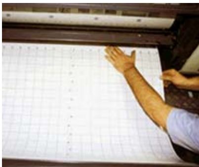
Abbildung 6.6 Magnetfolie zur Aufnahme der Stanzwerkzeuge [52]
