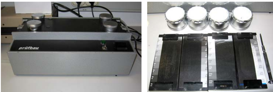
Abbildung 2.10 Prüfbau-Scheuertestgerät „Quartant“ und Spannschienen mit Gegenstücken
