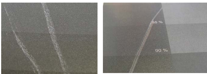
Abbildung 5.39 Fingernagelkratztest, Folienoberfläche bedruckt „printcom“ und „CureInk-UV“ (von links)
